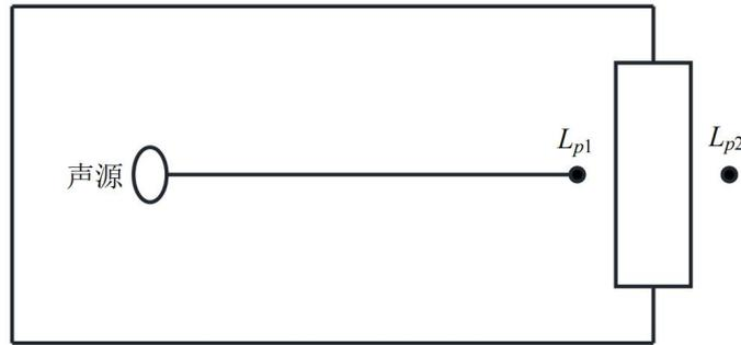
图 4.3-1 室内声源等效为室外声源图例
